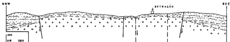
FIG. 10 : SECÇÃO GEOLÓGICA MOSTRANDO O DOMÍNIO E LIMITES DO ALTO ESTRUTURAL DO "TEMPO DA SEDIMENTAÇÃO" NOS METACONGLOMERADOS DO DISTRITO DE EXTRACÇÃO.
